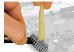
Raccordement des conducteurs, avec outil de manipulation
