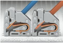
Insertion pour raccorder les conducteurs rigides.
