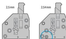
Une cavité sur la face arrière de la borne sert de distinction des pas.
