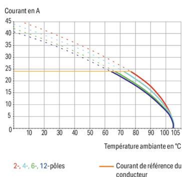
Borne pour circuits imprimés série 256 avec introduction du conducteur vers la platine de 45 °
