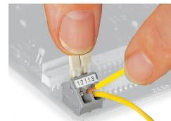
Connexion/Déconnexion des conducteurs – Actionnement manuel – Série 256.
