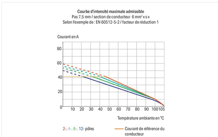
Borne pour circuits imprimés série 2606 pas de 7.5 mm
