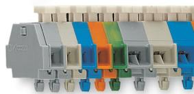
Barrette à bornes avec pieds de fixation à encliqueter, pour épaisseur de tôle 0,6 ... 1,2 mm, diamètre de trou de fixation Ø 3,5 mm (aussi pour rail aluminium 210-154 ou avec pied de montage 209-120 sur rail DIN 35)
