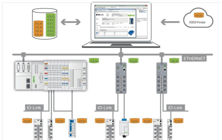
Le configurateur WAGO IO-Link Configurator permet la configuration et le paramétrage ainsi que l'exploitation et la surveillance des maîtres WAGO IO-Link pour le système WAGO I/O 750 System et le système WAGO I/O System Field, et en particulier des appareils WAGO IO-Link-Devices qui y sont connectés.
