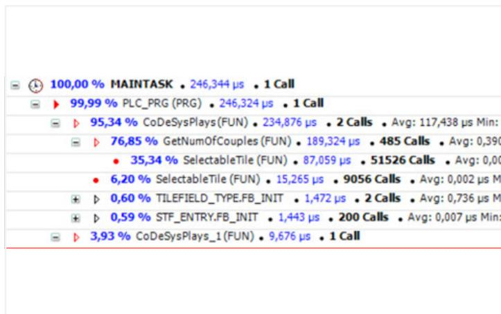
L'add-on e!COCKPIT Profiler permet aux programmeurs et aux développeurs d'application de mesurer et d'évaluer les temps d'exécution et la couverture de code des différents composants d'une application CEI 61131-3 à un stade précoce, et peut être intégré de manière transparente au logiciel d'ingénierie e!COCKPIT. La mesure peut être effectuée parallèlement au développement de l'application dans l'environnement de développement habituel.
