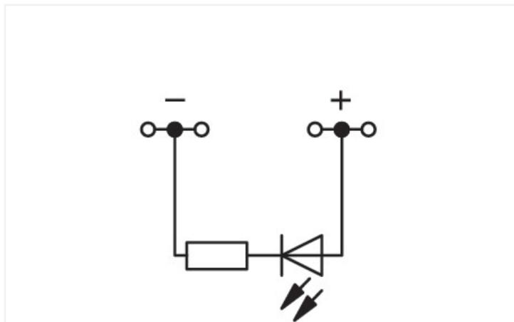
Component terminal block with led série 279 avec CAGE CLAMP®
