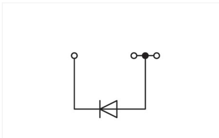
Component terminal block with diode série 280 avec CAGE CLAMP®
