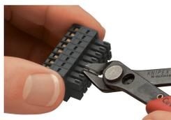
Codage d'un connecteur femelle en séparant les tiges de codage.
