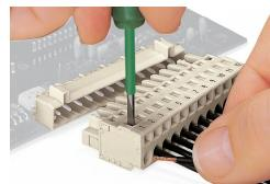
Raccordement du conducteur – manipulation de la connexion CAGE CLAMP® avec outil de manipulation (largeur de lame 3,5 mm) - perpendiculairement à l'axe du conducteur.
