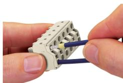
Les conducteurs rigides et les conducteurs souples  $\geq 0,5 \text{ mm}^2$  munis d'embout d'extrémité sertis peuvent être insérés directement. Via les points de test, on peut réaliser un contact direct avec des pointes de test.
