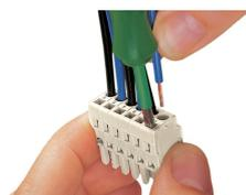
Raccordement du conducteur – manipulation de la connexion CAGE CLAMP® avec outil de manipulation (largeur de lame 3,5 mm) - dans l'axe du conducteur.
