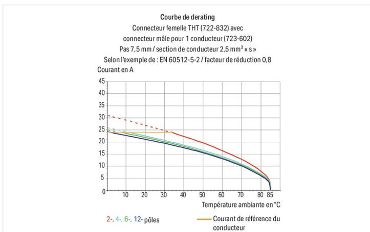
Connecteur femelle série 722 avec dimensions de la goupille de soudage 0,6 x 1 mm
