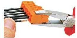
Raccordement du conducteur à l'aide de l'outil de manipulation
