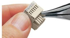
Détrompage d'un connecteur femelle – détacher la (les) tige (s) de codage.
