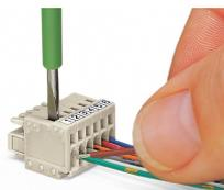
Raccordement du conducteur – avec outil de manipulation (2,5 x 0,4) mm. Perpendiculairement à l'axe du conducteur.
