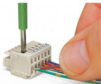
Raccordement du conducteur – avec outil de manipulation (2,5 x 0,4) mm. Perpendiculairement à l'axe du conducteur.
