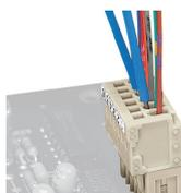
Tester avec fiche de test Ø 1 mm, réf. 735-500, Contact direct
