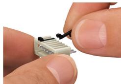
Détrompage d'un connecteur mâle - encli-
