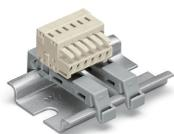
À partir de 3 pôles montage sur rail DIN 35 avec deux adaptateurs de montage (209-137) ; distance entre deux adaptateurs de montage maximum 7 pôles
