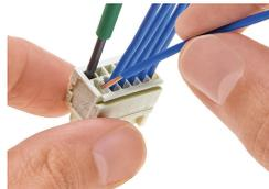
Raccordement du conducteur – manipulation de la connexion CAGE CLAMP® avec outil de manipulation (2,5 x 0,4) mm dans l'axe du conducteur.
