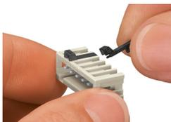
Détrompage d'un connecteur mâle - encli-
