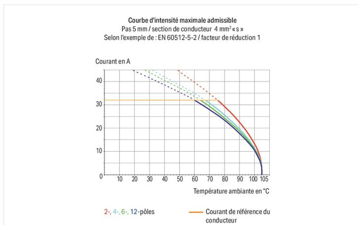
Borne pour circuits imprimés série 745 avec introduction du conducteur vers la platine de 45 °
