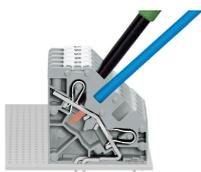
Raccordement des conducteurs souples avec un tournevis (largeur de lame 5,5 mm)
