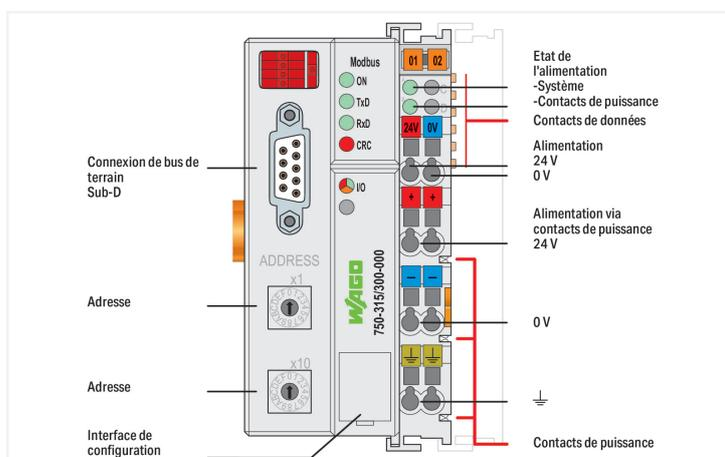
Ce coupleur permet de connecter les bornes WAGO-I/O-SYSTEM au réseau MODBUS en tant que station esclave.
