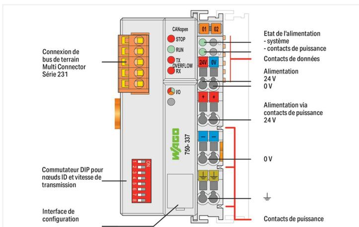
Ce coupleur permet de connecter les bornes WAGO I/O System au réseau CANopen en tant que station esclave. Les données sont transmises avec des PDO et SDO.
