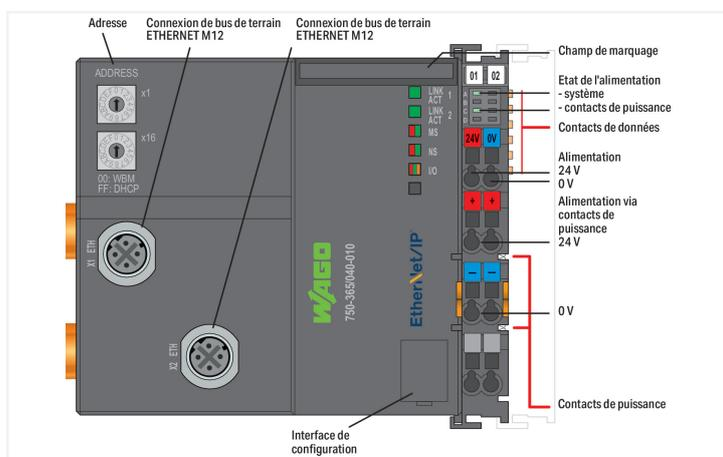
Le coupleur EtherNet/IP™ relie le système modulaire WAGO I/O System avec le réseau EtherNet/IP™.
