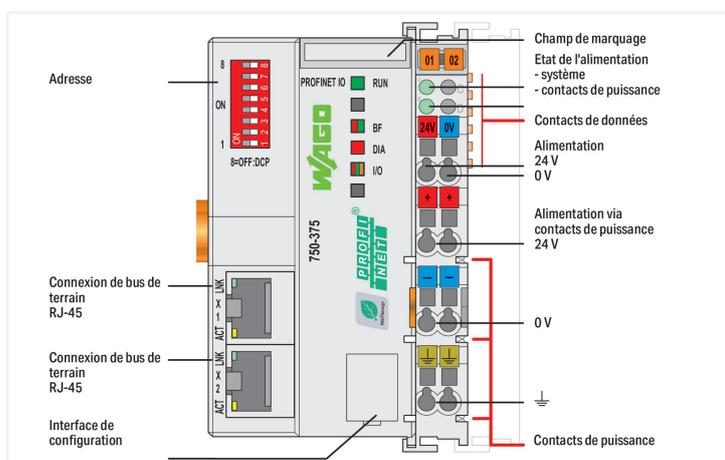
Ce coupleur de bus de terrain permet de connecter le système WAGO-I/O-SYSTEM 750 au réseau PROFINET IO, le standard industriel ouvert ETHERNET temps réel pour l'automatisation.
