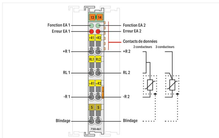
La borne d'entrées analogiques permet une connexion directe de sondes de température Ni.
