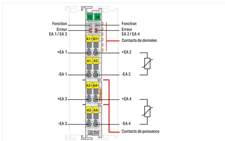
La borne d'entrées analogiques permet la connexion directe de capteurs NTC
