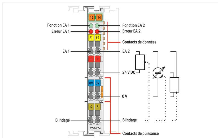
La borne d'entrées analogiques est chargée d'alimenter les convertisseurs de mesure se trouvant sur le terrain et de transmettre au système le signal analogique séparé galvaniquement.
