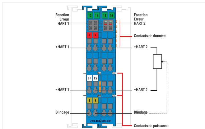
La borne d'entrées analogiques sert à la connexion de deux convertisseurs de mesure avec interface HART intégrée qui sont placés dans des milieux à risque d'explosion des zones 0+1.
