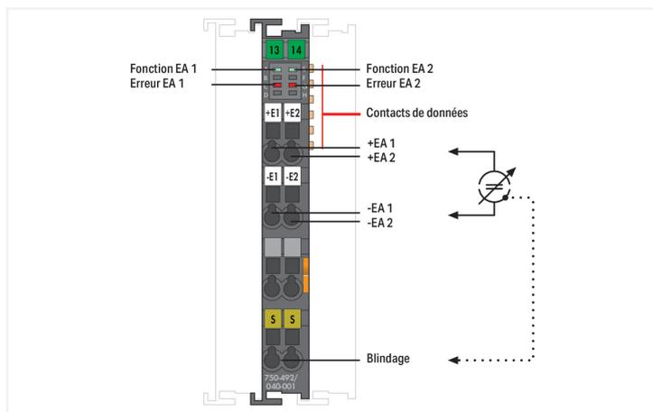
La borne d'entrées analogiques traite des signaux différentiels sur une plage de courant standardisée de 4 ... 20 mA.
