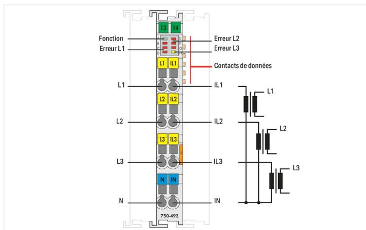
La borne de mesure de puissance à 3 phases permet la mesure des données électriques d'un réseau de distribution triphasé.
