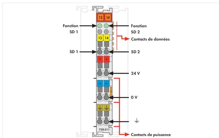
Avec cette borne de sorties, une information 16 bits est modulée en fréquence. La transmission côté terrain se fait avec séparation galvanique parfaite. La fréquence se calcule sur la base d'une unité d'adressage de 10 bits avec une résolution de 2 Hz/Digit. Le rapport pause/impulsion est réglé côté usine à 50%.
