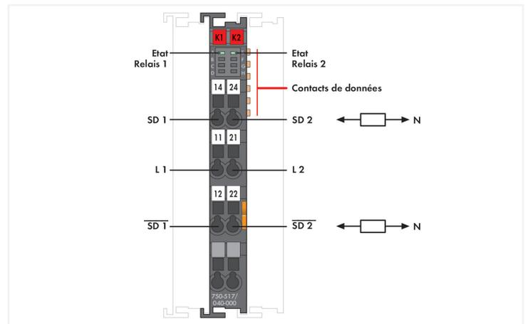
L'automate programmable transmet ses signaux de commande aux actionneurs connectés par l'intermédiaire des bornes de sorties digitales. La commande du ou des relais dépend de l'environnement interne.
