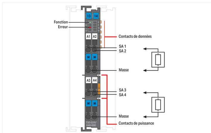
La borne de sorties analogiques génère des signaux analogiques sur une plage de tension standardisée de 0 ... 10 V. Le signal de sortie est séparé galvaniquement et le transfert au coupleur se fait sur une unité d'adressage de 12 bits. La borne est alimentée par la tension interne du système via un convertisseur DC/DC. Les canaux des bornes de sorties possèdent un potentiel de référence commun.
