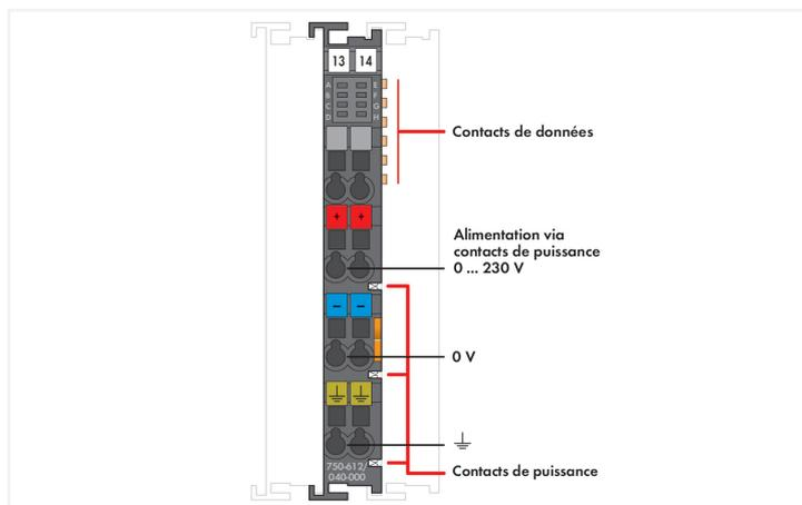
Cette borne d'alimentation alimente les diverses bornes de bus de terrain par les contacts de puissance.
