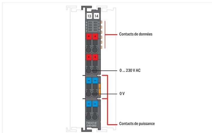
La borne de distribution de polarité met à disposition plusieurs points de connexion pour la tension d'alimentation. Il n'est dès lors plus nécessaire d'utiliser des bornes sur rail externes supplémentaires.
