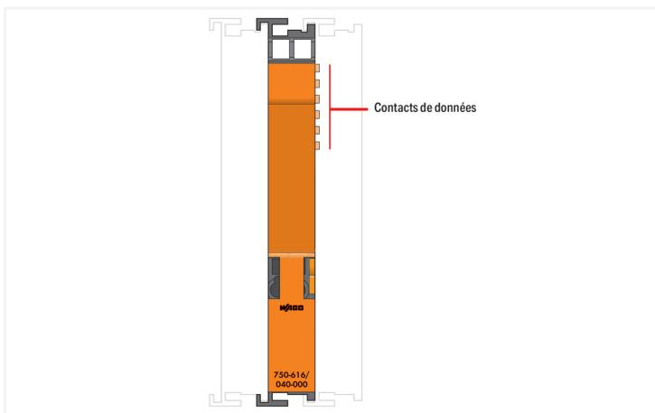
La borne intermédiaire divise visuellement le nœud de bus de terrain en différentes sections, comme par ex. en unités de fonction différentes, qui seront traitées dans un nœud de bus de terrain.
