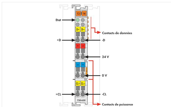
La borne est l'interface pour la connexion directe d'un codeur SSI.
