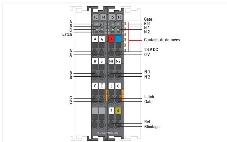
La borne d'interface offre la possibilité de connecter tous les types de codeurs incrémentaux avec différentes connexions. Il lui est possible de lire ou d'activer un compteur avec un démultiplicateur polaire de même qu'un latch avec mise à zéro. La commande peut écrire ou transmettre la valeur du compteur. Selon le mode de fonctionnement, lors d'un front montant sur l'entrée « C » ou « Latch », la valeur du compteur est transmise au registre du latch et la valeur du compteur est initialisée.
