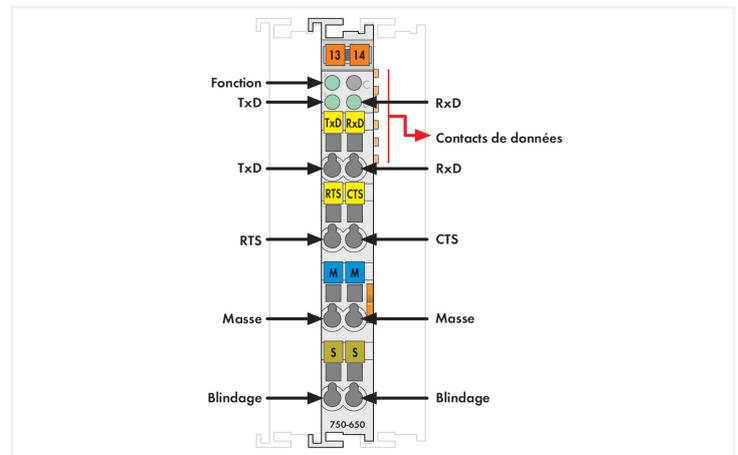
L'interface intégrée dans la borne de bus permet la connexion d'appareils avec une interface RS-232-C.
