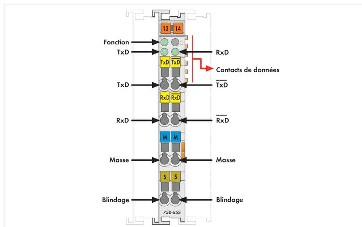
L'interface intégrée dans la borne de bus permet la connexion d'appareils avec une interface RS-485.
