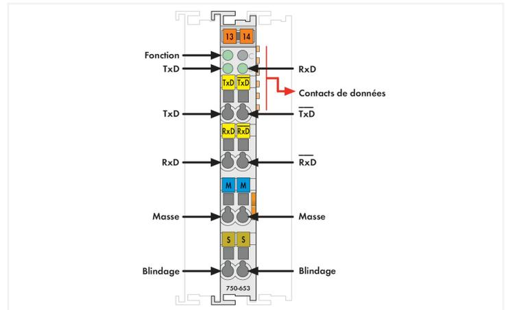
L'interface intégrée dans la borne de bus permet la connexion d'appareils avec une interface RS-485.
