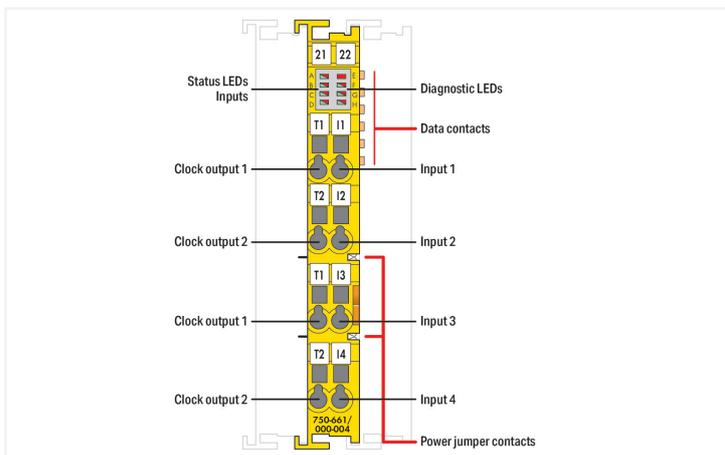
Il est possible de connecter avec la borne PROFIsafe, réf. 75x-661/000-004, des boutons d'arrêt d'urgence libres de potentiel, des interrupteurs de portes de protection, des commutateurs de mode, des capteurs de sécurité ainsi que des sorties à semi-conducteurs de sécurité.
