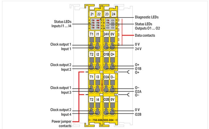
La borne 750-666/000-004 est munie de 2 sorties de puissance (O1 ... O2) et de 4 entrées reconnaissant les signaux d'horloge de contrôle (I1 ... I4). Les capteurs peuvent être alimentés directement par une tension de 24 V ou par l'intermédiaire des 2 sorties de synchronisation différentes (T1 ... T2).
