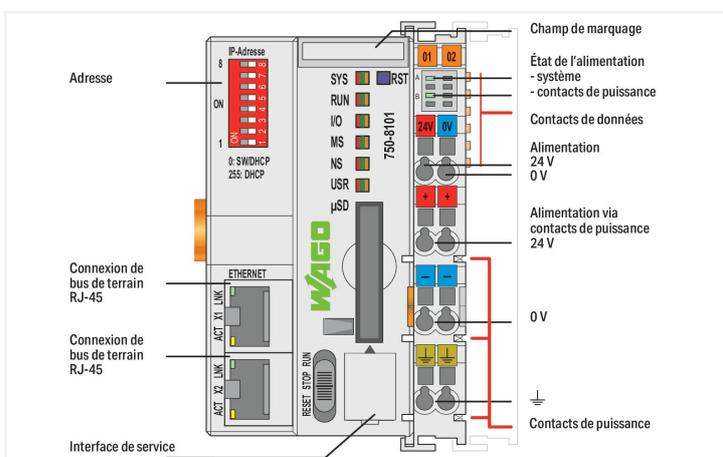
Le contrôleur PFC100 est un automate compact du système modulaire WAGO I/O System. En plus des interfaces réseau et de bus de terrain, il supporte des bornes digitales, analogiques ainsi que des bornes spécifiques des séries 750/753.
